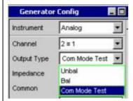
Remote control command: OUTPut:TYPE CTESt
